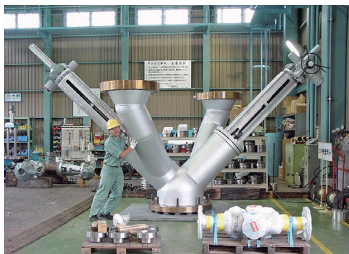
プラントに設置される巨大な特殊バルブ。製造だけでなく、専門技術を生かしてメンテナンスも行う
