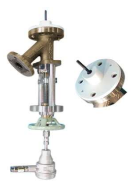
TI type (디스크 하강 개방형) 10K-2" × 1.5" 플랜지 타입 온도계 일체형, PTFE 라이닝 시트
