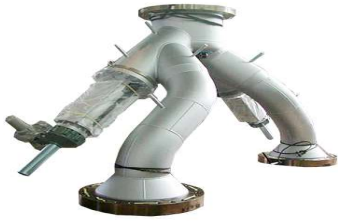
W3Z type 3 방향 밸브 (격리 밸브; isolation valve) 150psi-34"/28" × 28"/24" 재킷 일체형 전동 조작
