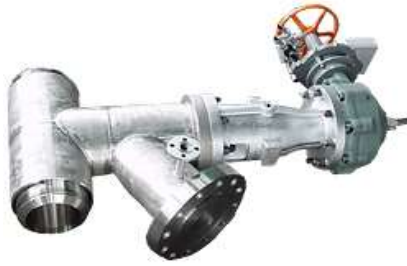
SP type(세로형) 2500psi-12"/10"BW × 8"/6"RF 재킷 일체형 에어 모터 조작
