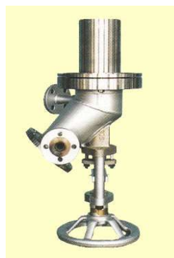
TO type (디스크 상승 개방형) 150psi-5"3/4" × 3"1/2" 플랜지 타입 재킷 일체형
