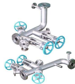
Válvula de globo de Y 300psi- 5"/3" con camisa y dos válvulas de drenaje de 2"
