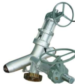
Válvula de globo de Y 900psi- 8"/5" con camisa y dos válvulas de drenaje de 3"
