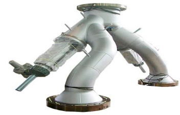
طرز W3Z صمام ثلاثي الشعب عازل 150psi-34"/28" x 28"/24" توصيل مع حافة الأنبوب مغلف، تشغيل بواسطة محرك كهربائي
